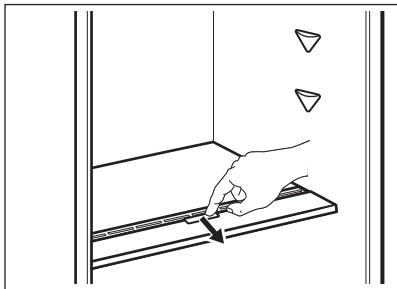
Chcete-li zařízení pro regulaci vlhkosti vyjmout, otevřete zásuvku pod skleněnou policí a vytáhněte kryt.
