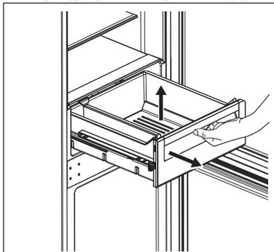
2. Wsunąć prowadnice do środka, aby zapobiec uszkodzeniu urządzenia przy zamykaniu drzwi.
