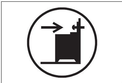
1. Nainstalujte ochranu proti překlopení 317 - 322 mm pod úroveň horní plochy spotřebiče a 80–85 mm od boční strany spotřebiče skrze kruhový otvor na konzoli. Přišroubujte jej do pevného materiálu nebo použijte vhodnou oporu (zeď).
