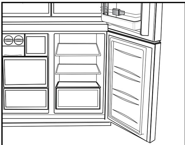
1 - Utěsnění je zajištěno, když je těsnění na dveřích přitisknuto na povrch pohyblivé střední části, přičemž dveře prostoru chladničky jsou zavřené.
